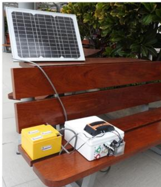
Fig. 3: Sensores de calidad de aire ( CO_2 , VOC , SO_2 , O_3 + NO_2 , CO ) y meteorológicos: temperatura ambiental, humedad relativa y presión barométrica.
