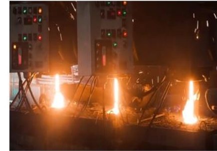
Paso 3: Se lleva a la composición química necesaria para realizar la barra
