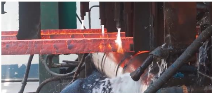
Paso 4: Se para por un proceso de enfriamiento por moldes de cobre con agua
