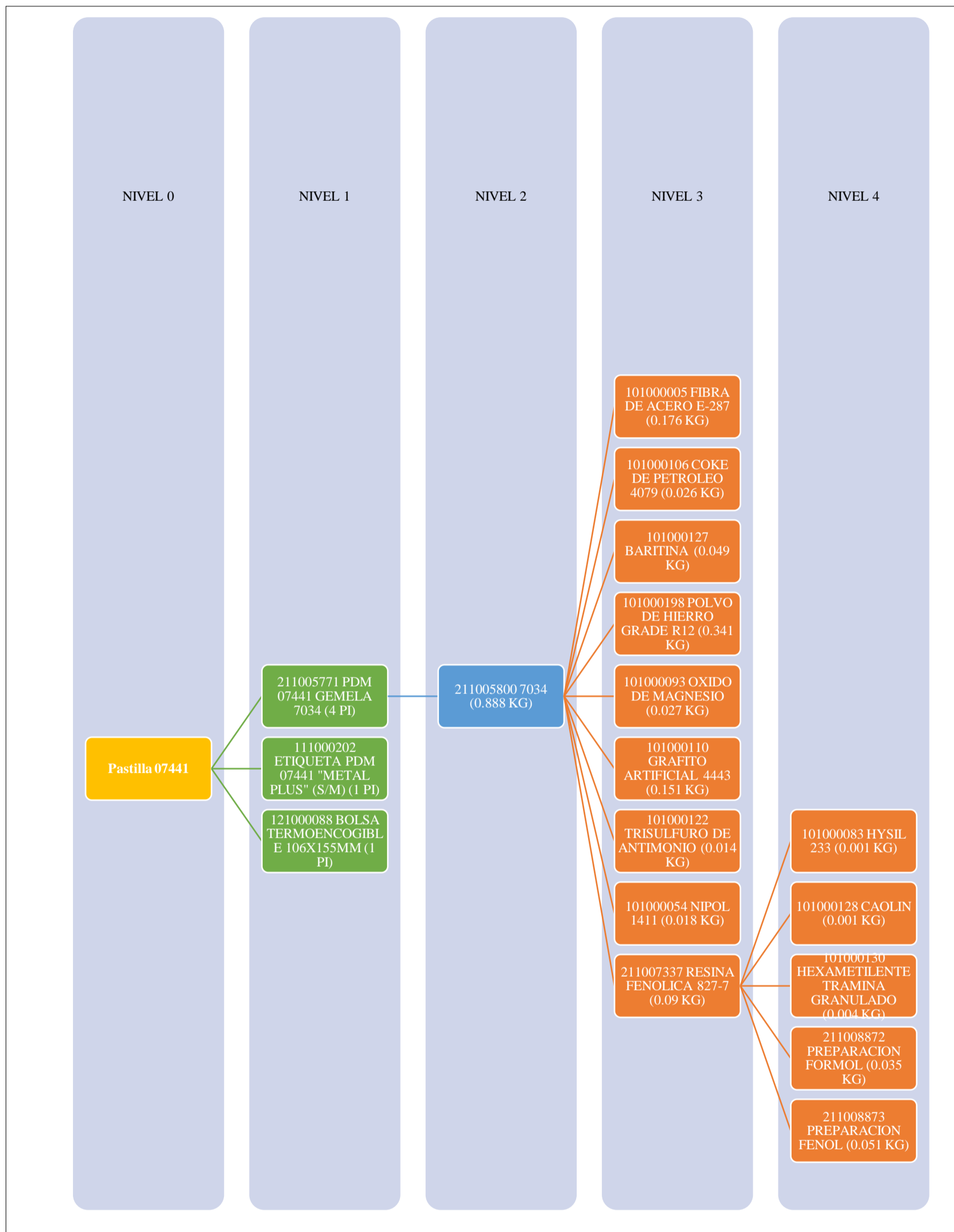
Gráfico 13. Descomposición por explosión de la pastilla
