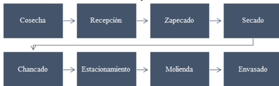
Gráfico 20. Proceso de elaboración yerba mate
