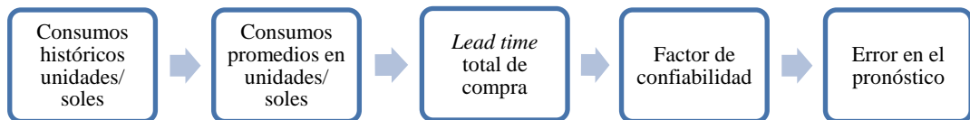
Gráfico 25. Secuencia de análisis para la obtención de los parámetros de MRP actualizados
