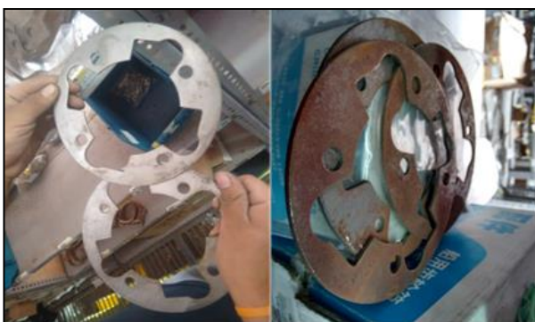
Gráfico 16. Vista de repuestos con signos de obsolescencia en almacén Sinomaq S.A.
